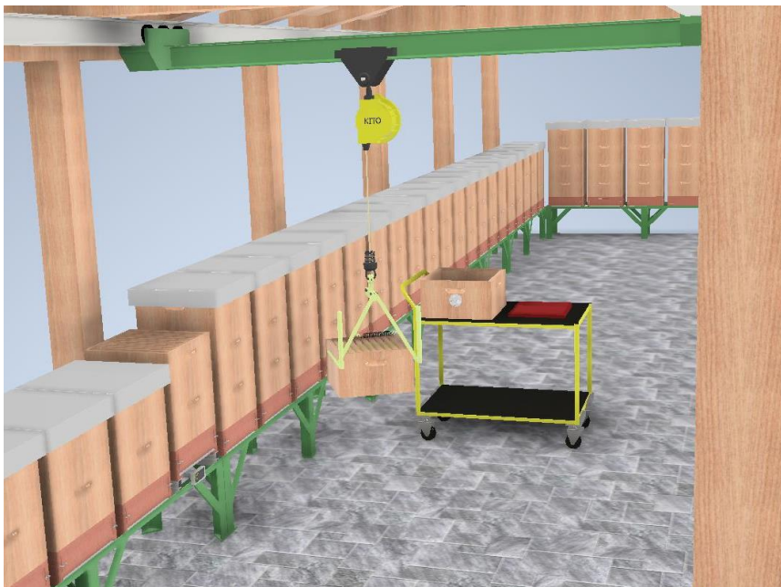
Obr. 9. Ukázkový příklad využití zdvihacího zařízení ve včelíně
