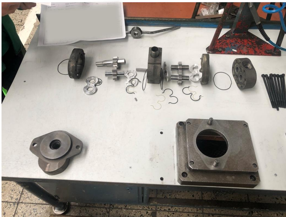
Obr. 2. Rozložené zubové čerpadlo
